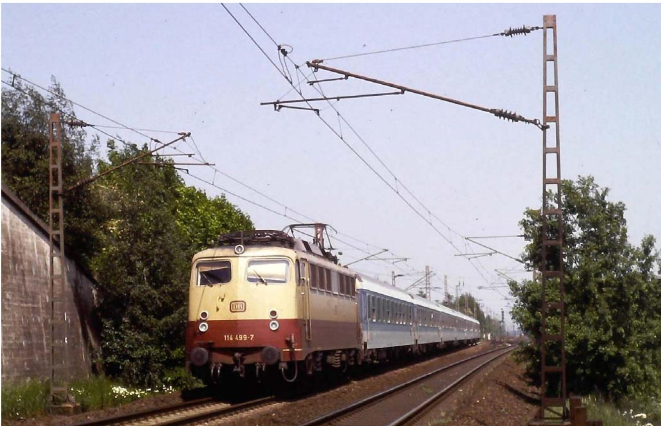
Die frei gewordenen Drehgestelle wurden als Ersatz für defekte Drehgestelle der BR 114 (wie die BR 113 aus der 112 entstanden) verwendet. Gleichzeitig wurden so umgebaute Maschinen in die Baureihe 110 integriert. Auch einen Umbau von einer 139 in eine 110 hat es gegeben.
