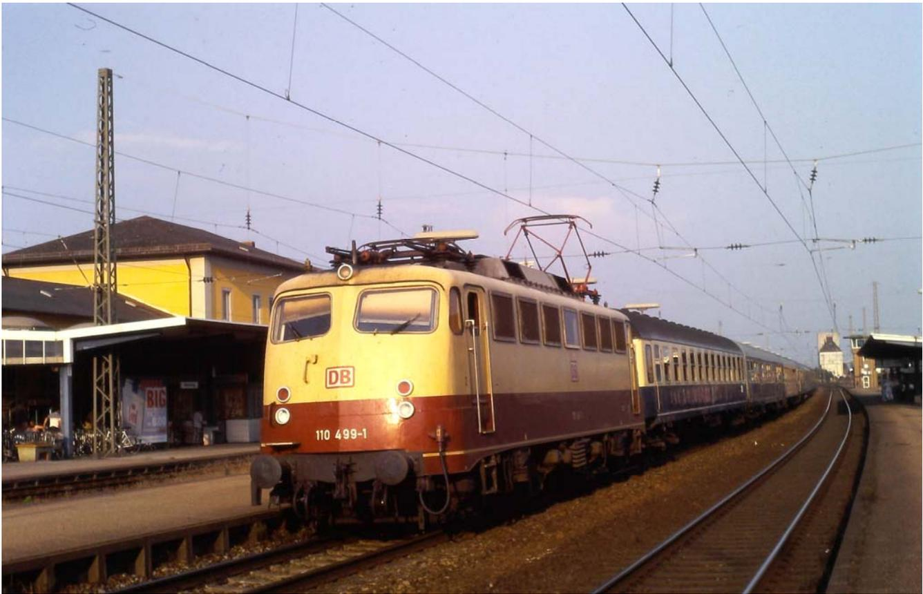
Eine Besonderheit waren die in rot-beige lackierten 110. Als man nämlich bei der DB feststellte, dass für den Verkehr mit der sogenannten Rollenden Landstraße zum Brenner zu wenig Loks mit Widerstandsbremse vorhanden waren, baute man 110er in 139er um.
