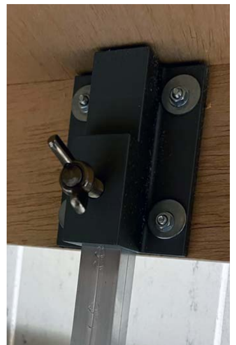
Oben: Abschlusskappe für die Standrohre mit Feinjustierung. Links: Grobe Skizze für die Halterung. Rechts: Fertig gedruckte Halterung mit M8-Mutter
